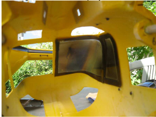
Collage des fenêtres a l'époxy lente...
