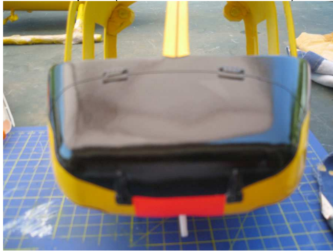
Le capot ... ( filet autocollant + chainières)
